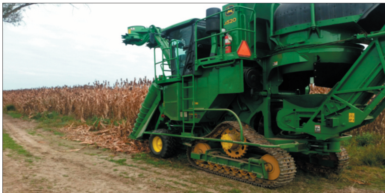
Figura 3: Cosechadora integral de caña de azúcar realizando labores en el cultivo de sorgo azucarado (Monte Toro, 2016).
