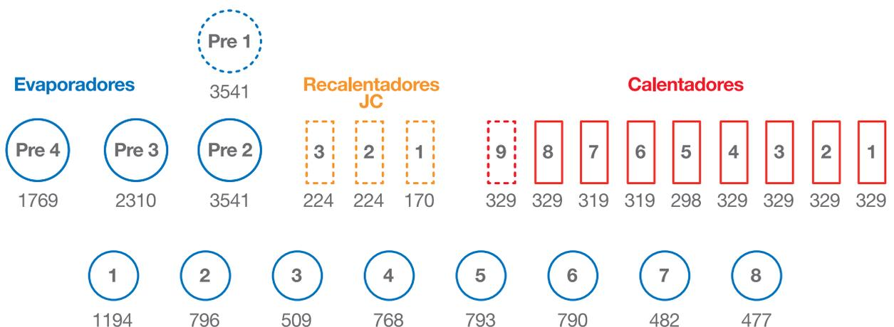
Figura 5. Esquema del Sistema Calentamiento y Evaporación correspondiente al año 2021.
