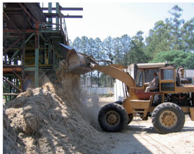
Figura 4. Carga y alimentación a la caldera.
