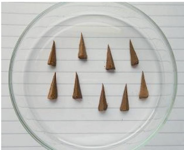
**Figura 2.** Conos de cenizas moldeados para el análisis de fusibilidad, según ASTM D1857-04, 2010.
