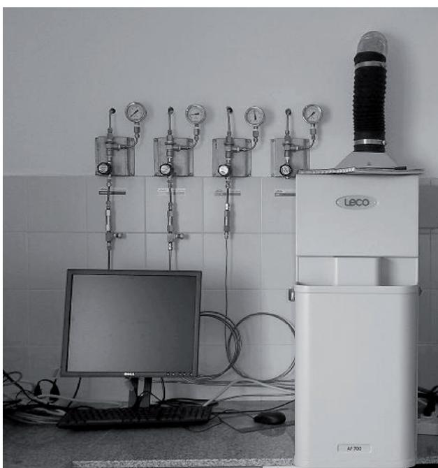
**Figura 3.** Equipo para la determinación de la fusibilidad de cenizas, marca LECO, modelo AF700, instalado en el LEMI-EEAOC.
