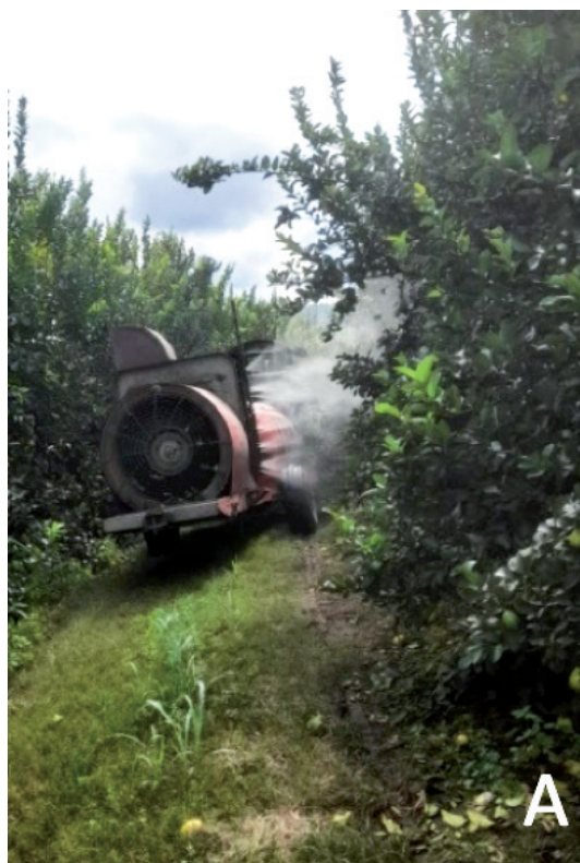
Figura 2. A: Aplicación de ensayo utilizando media a la de la turbo pulverizadora. B: Color y mojado de fruta en el momento de la pulverización.
