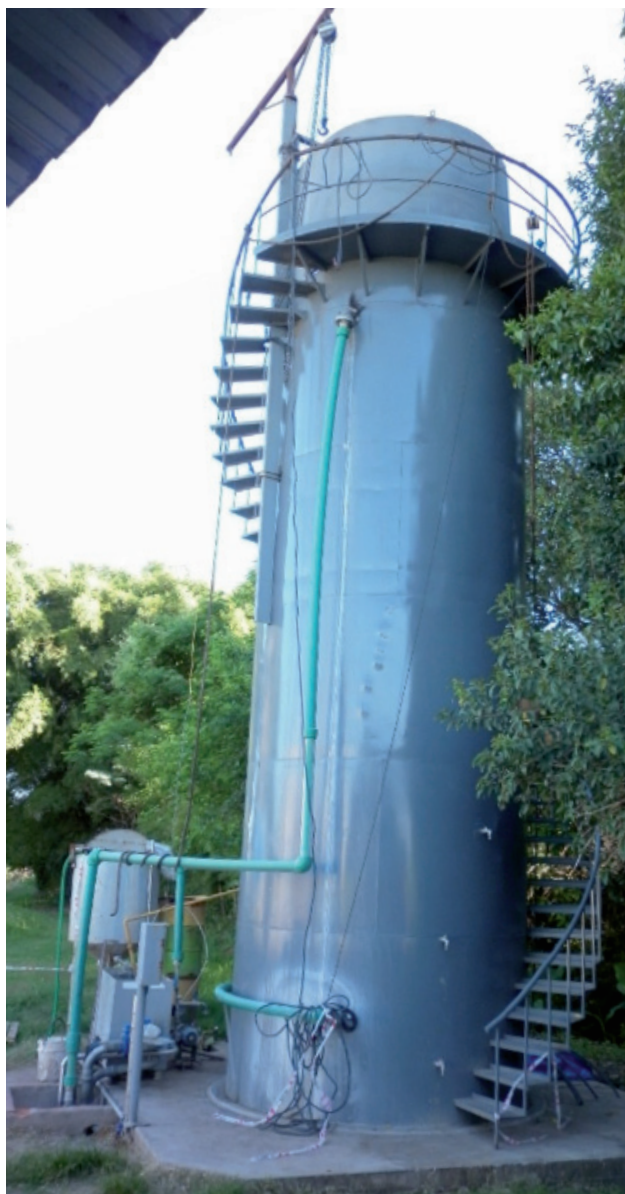
Figura 4. Biorreactor construido en la empresa Acheral SA.
