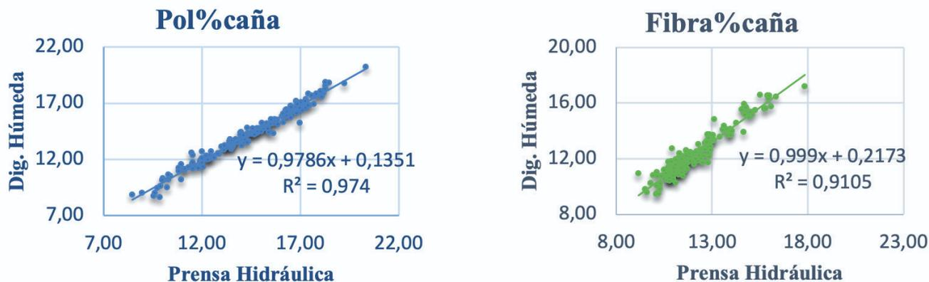
Figura 5. Comparación de métodos de prensa hidráulica y digestión húmeda. Regresión lineal para Pol%caña y Fibra%caña, ensayos realizados en 171 muestras.
